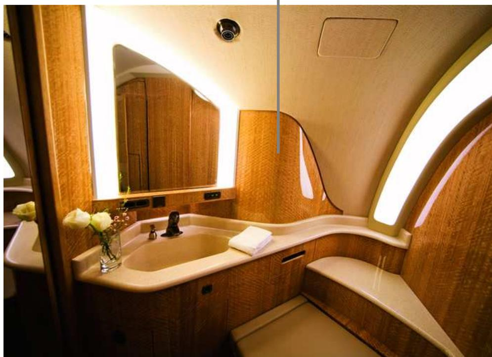
Figura 5.3 Exemplos de móveis com acabamento em veneer (cortesia Embraer).
