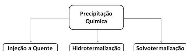
FIGURA 3.1 - Fluxograma contendo as metodologias empregadas para a síntese de óxido cúprico.
