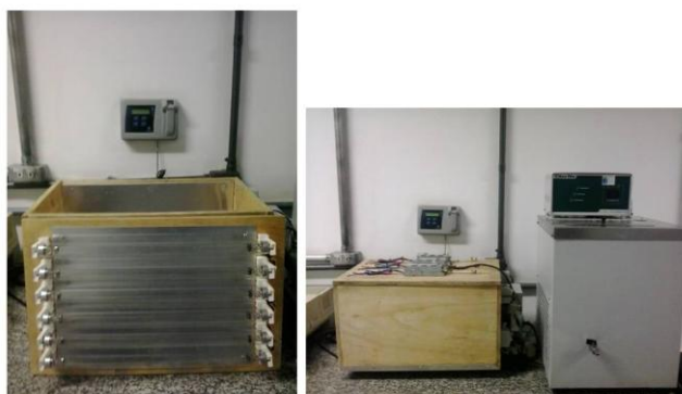
FIGURA 3.3 - Fotografia do fotorreator utilizado nos ensaios fotocatalíticos.
