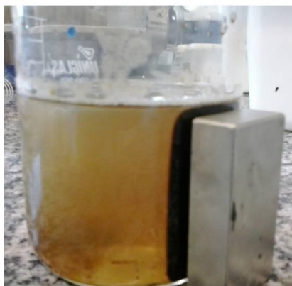
FIGURA 4.9 - Imagem da suspensão de nanopartículas do suporte magnético sendo atraídas por um ímã.
