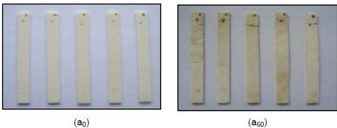
Figura 2.17 – Biodegradação do Ecoflex após 60 dias de ensaio ( a_0 = zero dia de ensaio, a_{60} = 60 dias de ensaio).
