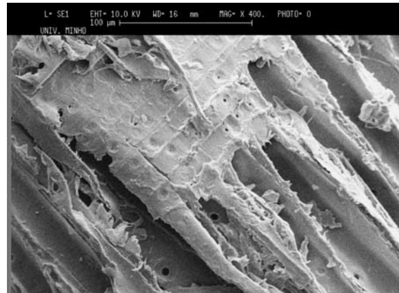
Figura 2.10: Estrutura de fendas tubulares observada na farinha de madeira [34].
