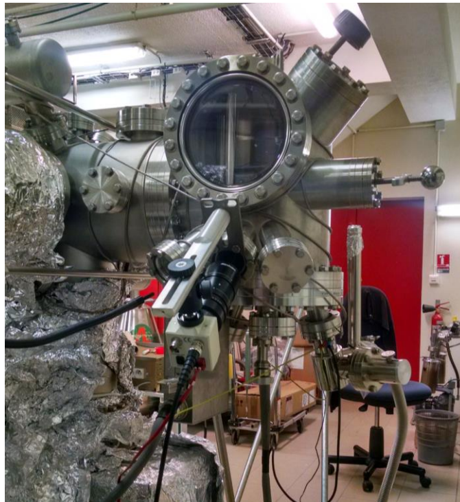
Figura 40: Câmara de análise STM, presente na mesma linha que o MBE;
