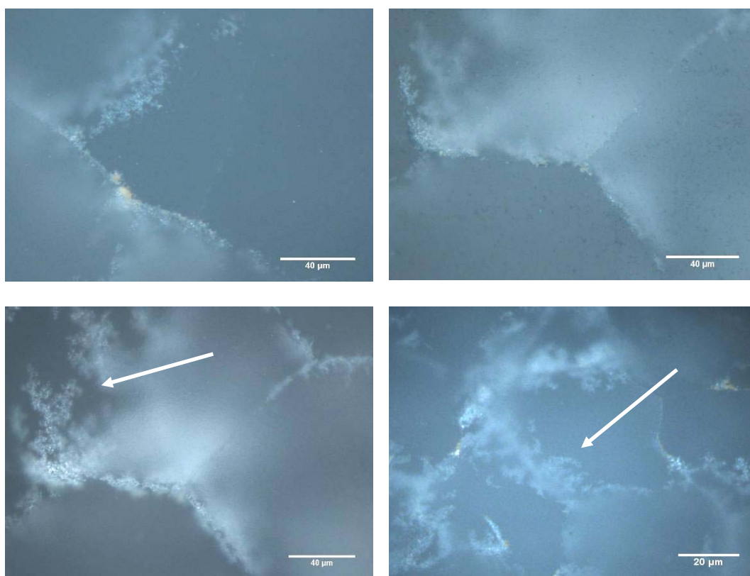
Figura 4.2 - Crescimento dendrítico da fase secundária no Biosilicato ® .
