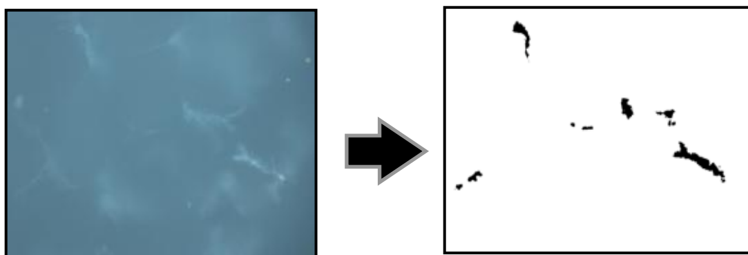
Figura 4.3 - Exemplo de imagem da amostra tratada a 900°C/20min, e a mesma imagem após o tratamento no software Image-J.
