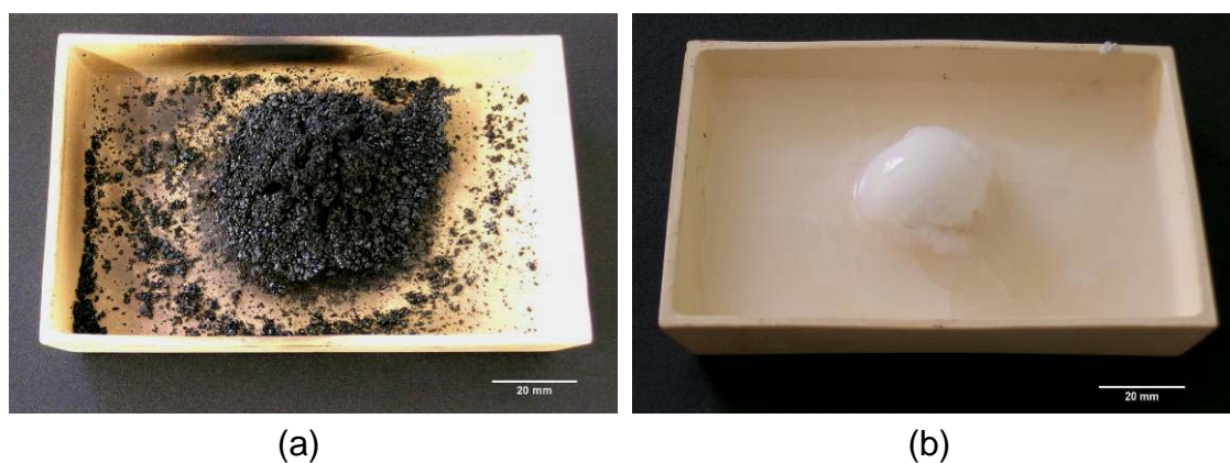
Figura 4.34 – Fusão e retração durante a queima do amido de milho (a) e das microesferas de polietileno (b).
