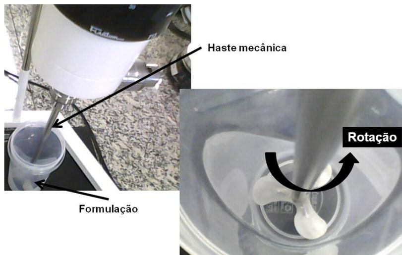
**Figura 3.2** Ilustração esquemática do aparato de mistura com haste mecânica.
