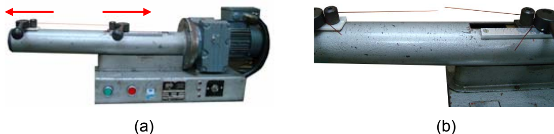
Figura A.3 (a) equipamento para ensaio de alongamento, (b) visão do marcador do valor da deformação no instante da ruptura do fio.
