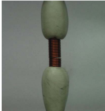
Figura 3.9 Corpo de prova no final do ensaio de tração com espira descolada.
