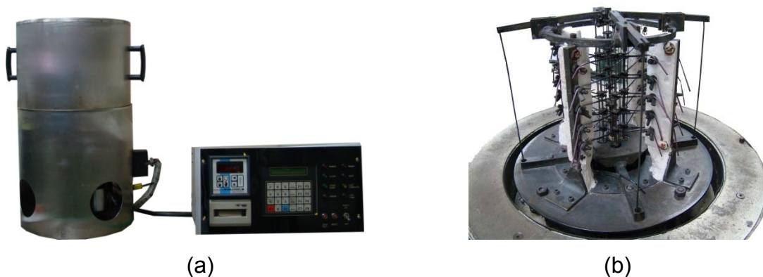
Figura A.6 (a) equipamento para ensaio de termoplasticidade lenta, (b) visão do forno aberto com corpos de prova.
