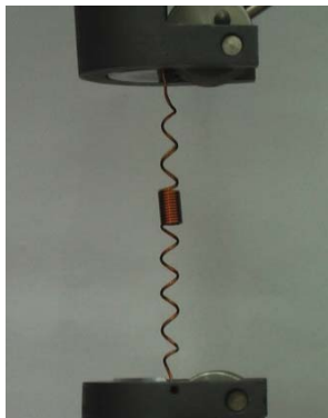
Figura 3.3 Corpo de prova durante o ensaio de rasgamento 1 da camada cementante.
