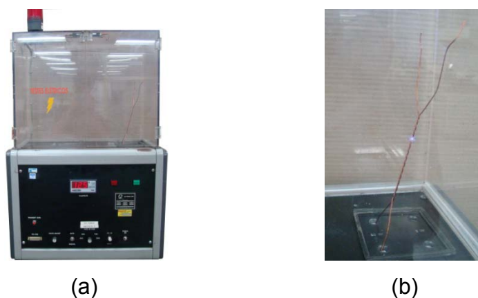
Figura A.2 (a) equipamento para ensaio de rigidez dielétrica, (b) visão do corpo de prova no instante do curto.
