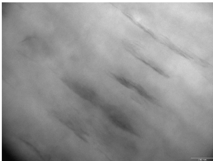
Figura 4.12 Micrografia (TEM) do filme de LDPE-EVA/OMMT obtido ao final da Etapa 2 (LDPE com 6%wt EVA/OMMT) (53000x - escala = 200 nm).
