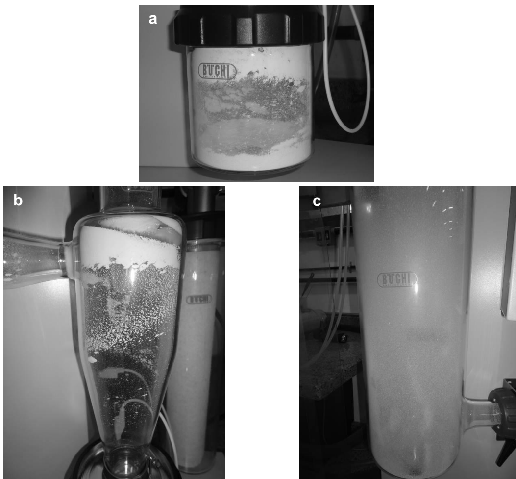
Figura 3.4 Partículas obtidas no frasco coletor (a), partículas retidas na parede do ciclone (b), casca de partículas aglomeradas no cilindro principal (c).
