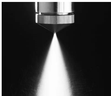
Figura 2.4 Imagem do atomizador e do spray do fluido já misturado com ar [15].
