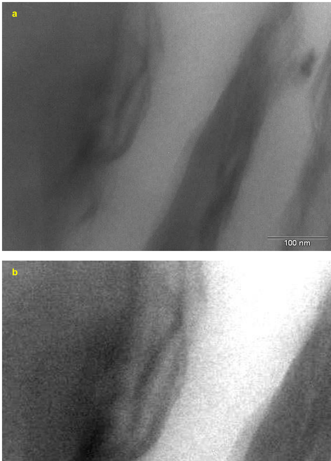
Figura 4.124 Micrografias (TEM) da amostra 28 do nanocompósito de LLDPE (MFI 29) com pó concentrado de spray drying (19%VA no EVA/5,0%OMMT): a) aumento de 88000x; escala = 100 nm; b) destaque de região de interesse.
