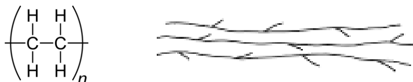
Figura 2.6 Ilustração da estrutura química do mero e representação esquemática do LDPE [17].
