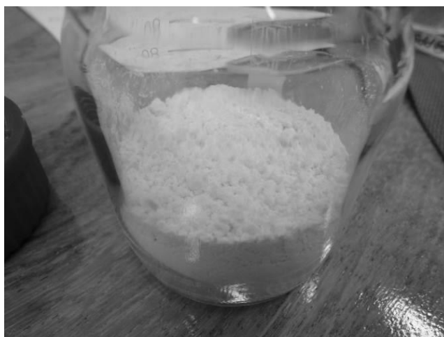
Figura 3.5 Fotografia do pó concentrado de EVA-argila obtido pelo processo de spray drying (proporção 1:1 em massa).
