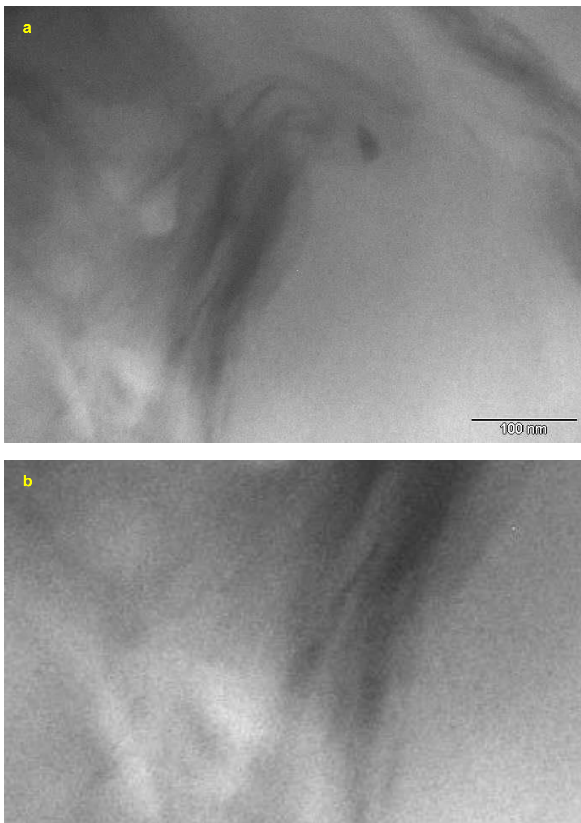
Figura 4.132 Micrografias (TEM) da amostra 23 do nanocompósito de LLDPE (MFI 29) com pó concentrado de spray drying (19%VA no EVA/7,0%OMMT): a) aumento de 88000x; escala = 100 nm; b) destaque de região de interesse.
