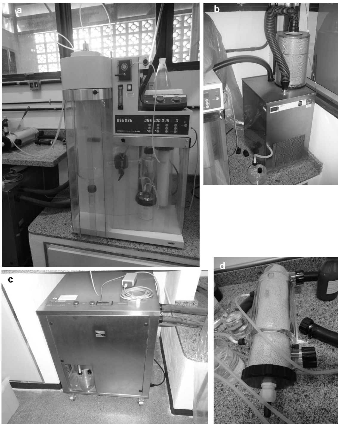
Figura 3.2 Imagens do Spray Dryer B-290 Advanced (a) e seus acessórios: Desumidificador B-296 (b), Inert Loop B-295 (c) e Coluna de Adsorção (d).
