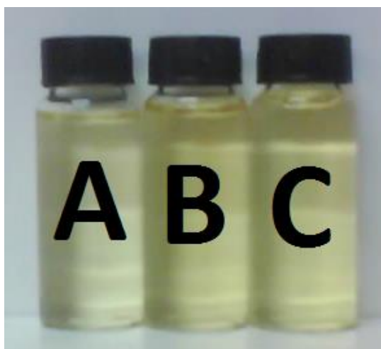
FIGURA 5.2 - Coloides de prata sintetizados em temperatura de: A) 90°C; B) 85°C e C) 80°C.
