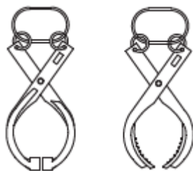
Figura 2.22 Exemplos de garras pantográficas para manuseio de postes de concreto [103] .
