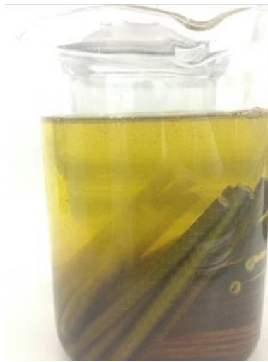
Figura 3.3 Barras de aço imersas em solução de ácido clorídrico e água, com hexametilenotetramina.
