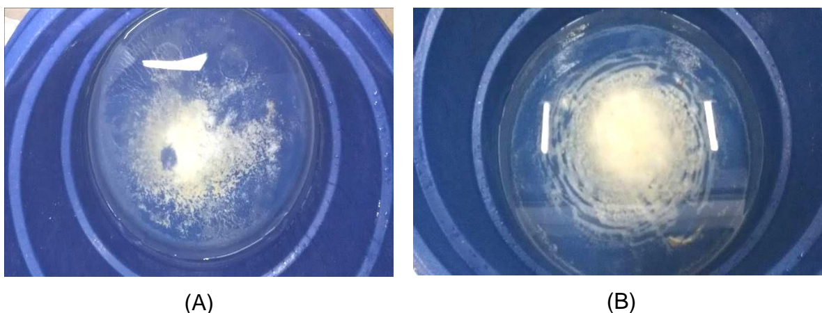
Figura 3.37 Intensa presença de precipitados na solução ao final do ensaio de envelhecimento em solução salina: (A) TSA e (B) TLV.
