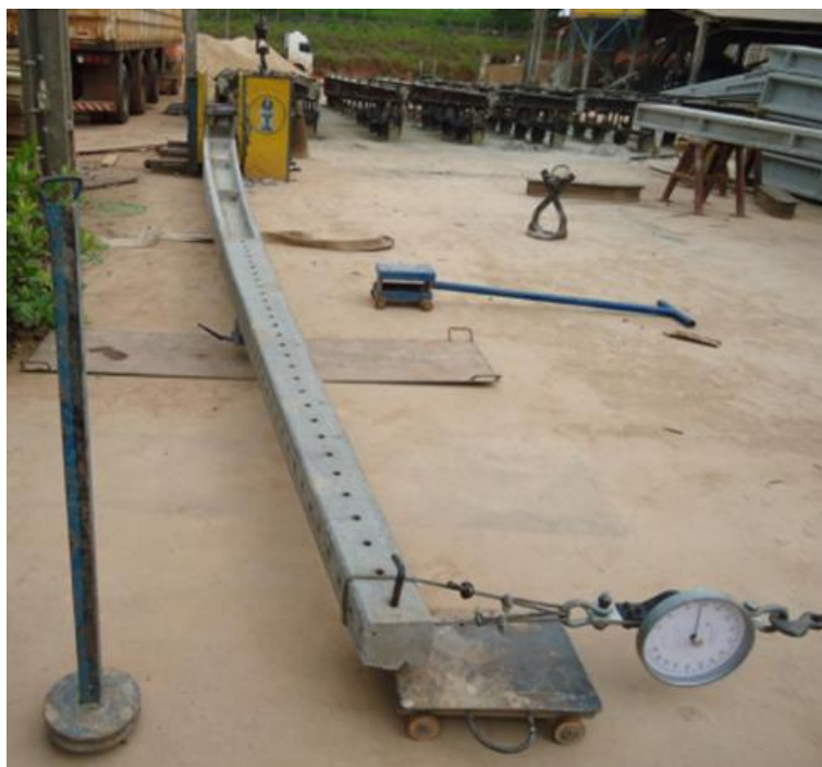
Figura 2.26 Poste flexionado durante ensaio de elasticidade.
