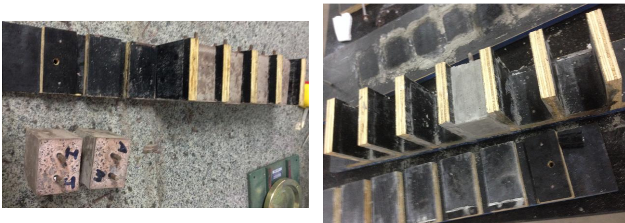
Figura 3.11 Moldagem de corpos de prova com barras metálicas para avaliação do potencial de corrosão.
