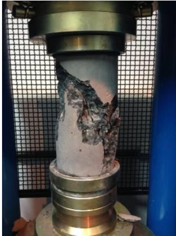
Figura 3.7 Ensaio de resistência a compressão axial.
