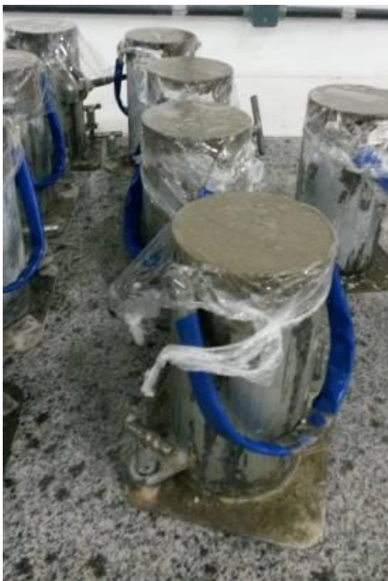
Figura 3.6 Filme de PVC transparente utilizado para vedar os moldes após a moldagem dos corpos de prova.
