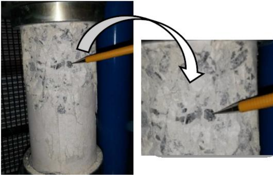
Figura 3.24 Corpo de prova do Traço de Laboratório 3 (TL3) apresentando fratura transgranular após ensaio de compressão axial.
