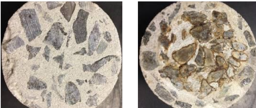
Figura 3.45 Comparação de um corpo de prova antes (esquerda) e depois (direita) de ser submetido ao ensaio de migração de cloretos, evidenciando a mudança da zona de transição.
