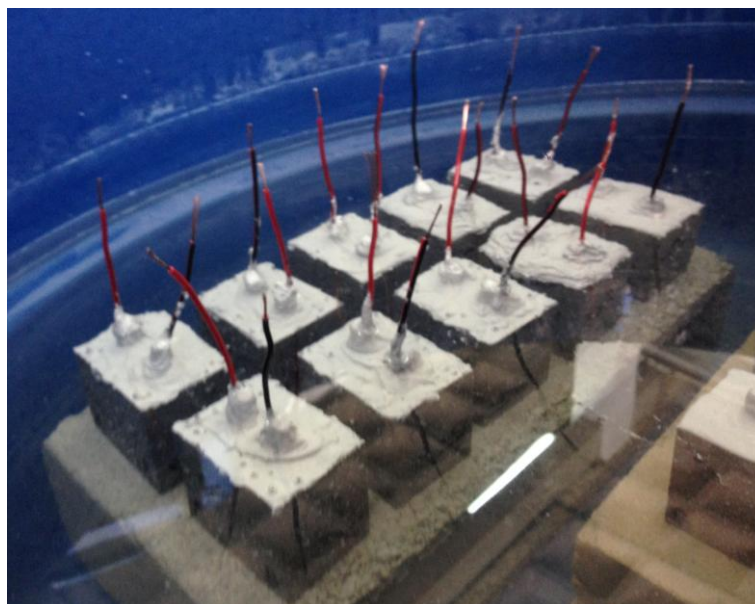
Figura 3.13 Corpos de prova para ensaio de potencial de corrosão, submetidos à cura imersa em água.
