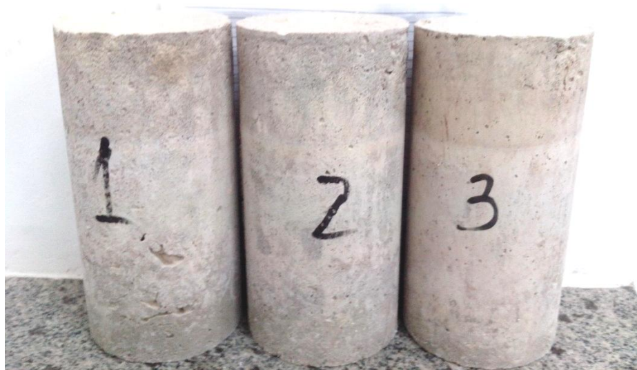
Figura 3.36 Corpos de prova após ensaio de envelhecimento em solução salina, com manchas esbranquiçadas, indicando possibilidade de eflorescência.
