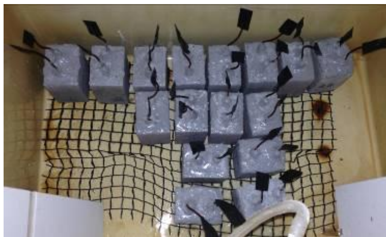
Figura 3.41 Disposição dos corpos de prova em câmara de envelhecimento salt spray .
