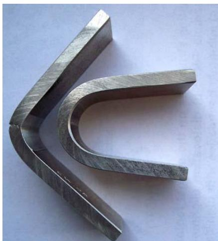
Figura 4.6 Exemplo de amostras testadas no ensaio de dobramento.
