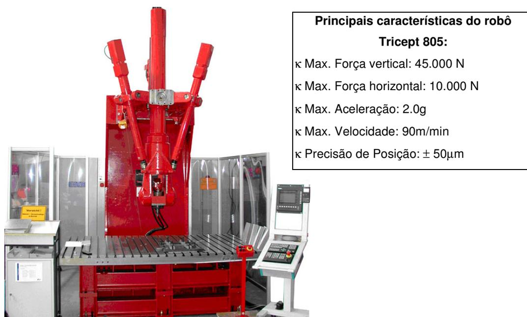
Figura 4.2 Robô Neos Tricept TR 805 e especificações técnicas.
