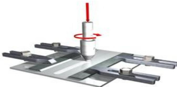
Figura 4.3 Fixação das placas na mesa de soldagem.
