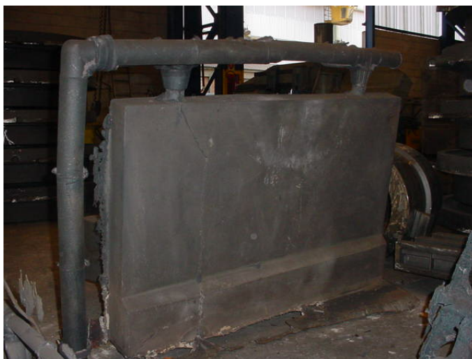
Figura 4.15: fotos de uma das placas teste de espessura de 90mm.
