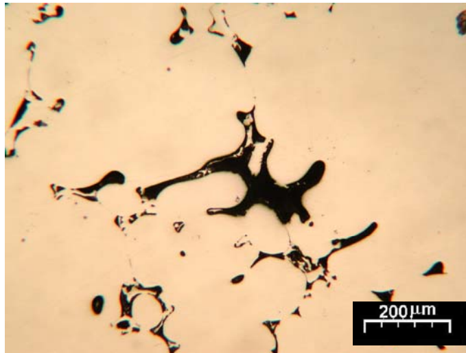
Figura 4.30: poros em placa fundida com o aço ASTM A743 CA15
