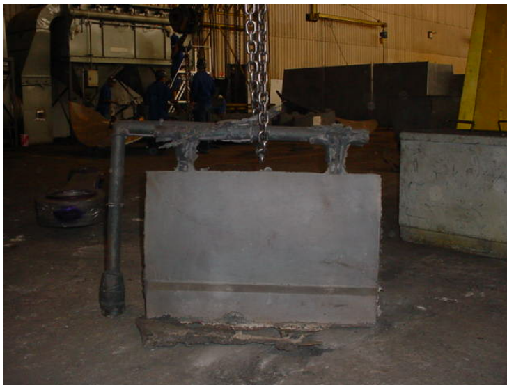
Figura 4.14: fotos de uma das placas teste de espessura de 60mm.
