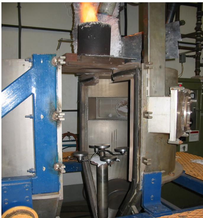
**Figura 3.2** Equipamento de conformação por spray.
