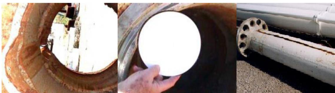
**Figura 2.11** Desgaste (*keyseating*) provocado na parede interna do riser de perfuração coincidente com o diâmetro externo da *tool joint* [48].
