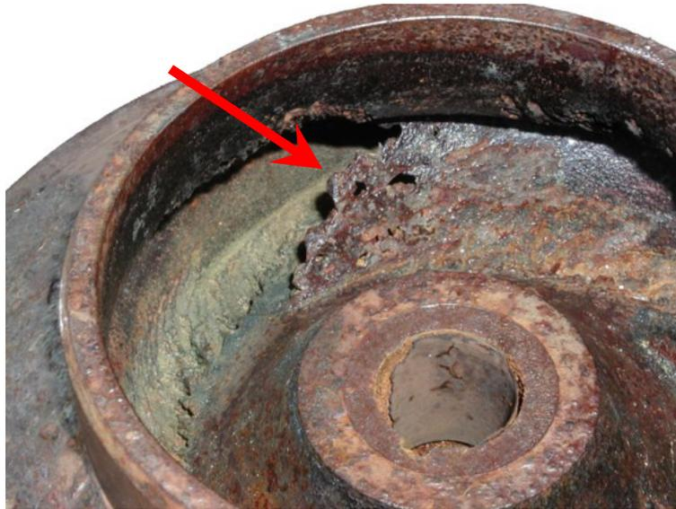
**Figura 2.8** Rotor de bomba de água desgastado por erosão-cavitação [30].
