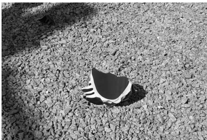
Figura 35 - Peça da porcelana do corpo do disjuntor que explodiu
