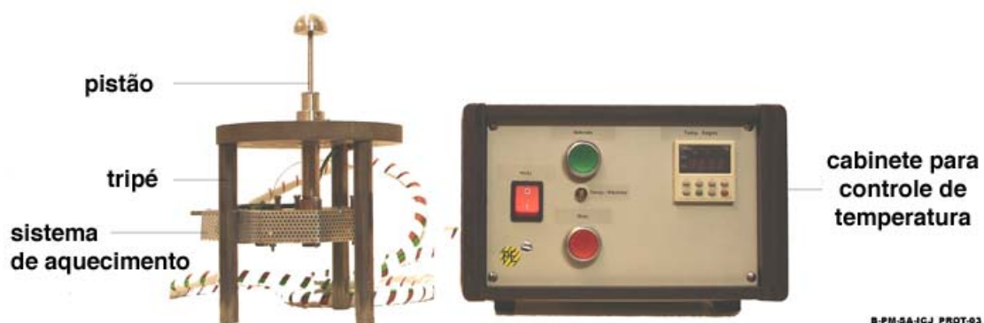
Figura A.1 – Protótipo para ICJ usado no projeto. Projeto GKSS Forschungszentrum GmbH (atual Helmholtz-Zentrum Geesthacht).
