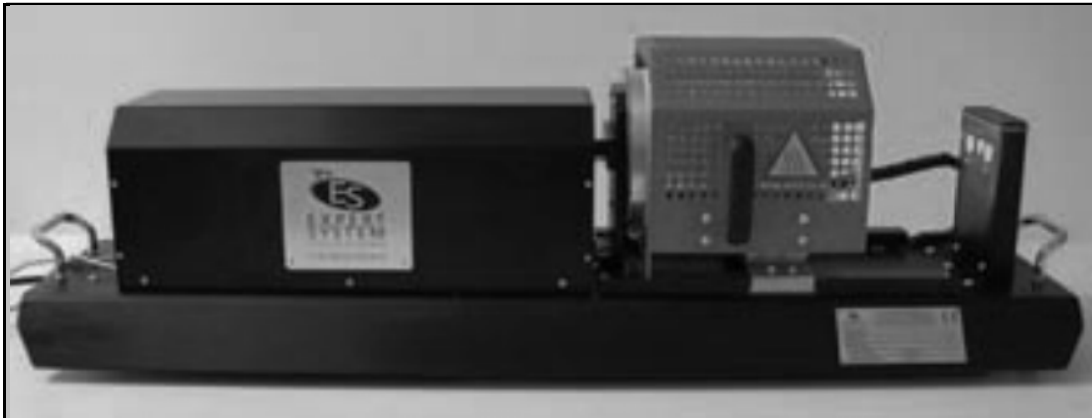
Figura 3.2 Flexímetro ótico – MISURA® FLEX-OLDT – de Expert System Solutions em Modena, Itália.
