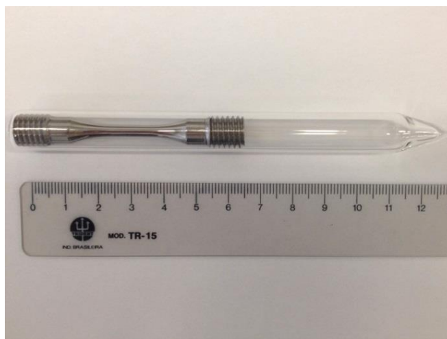
Figura 3.5 Corpo de prova encapsulado para tratamento térmico.
