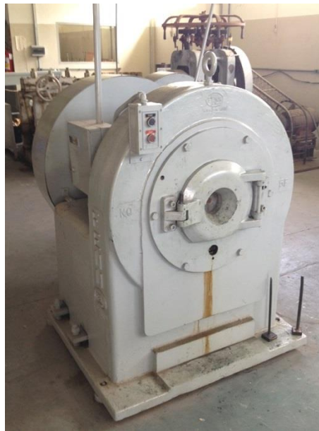
Figura 3.2 Equipamento FENN modelo 5F para forjamento rotativo.
