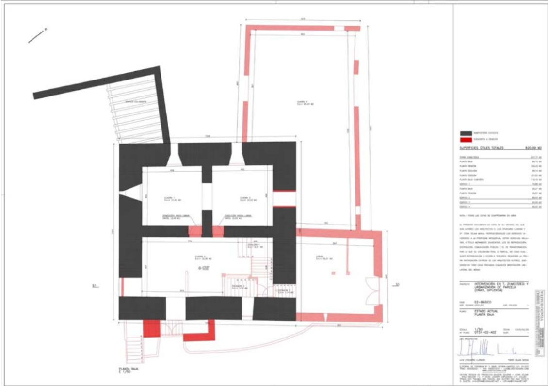
Fig. 2.70. Plano de Zumeltzegi [C05] no projeto de restauração dos arquitetos Itziar Zelaia e Luis Etxegarai. Em vermelho se indicam os “elementos a demolir”.
