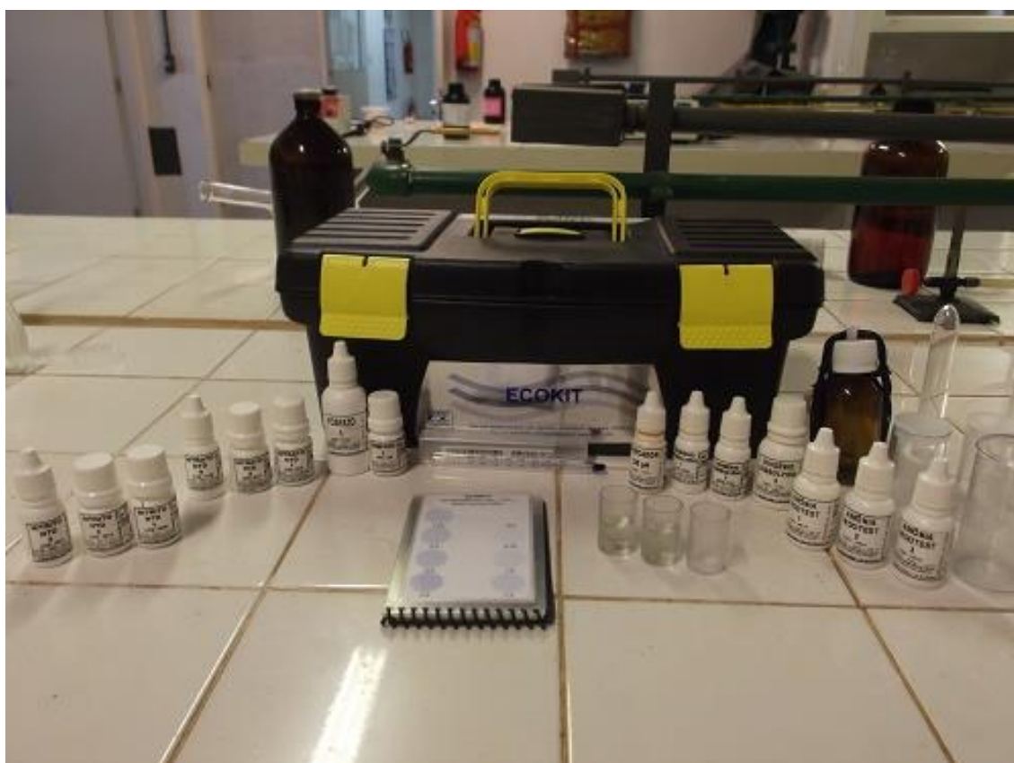
Figura 8. O Ecokit - ferramenta composta por frascos e reagentes para análise de parâmetros de qualidade da água pelo método colorimétrico. Fonte: do autor (2016).
