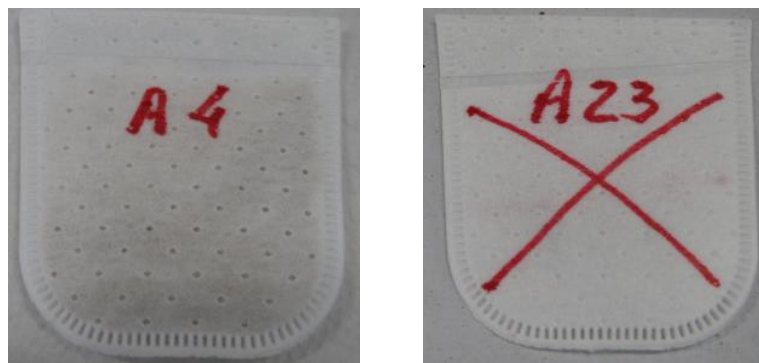
FIGURA 3.6- Filtros F57 (saquinhos) contendo amostra selada, utilizados no teste de digestibilidade.
