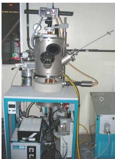
Figura 4.1 Forno a arco para elaboração de ligas
