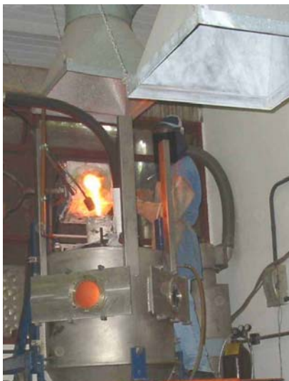
Figura 4.4 Equipamento de conformação por spray para atomização de pós.
