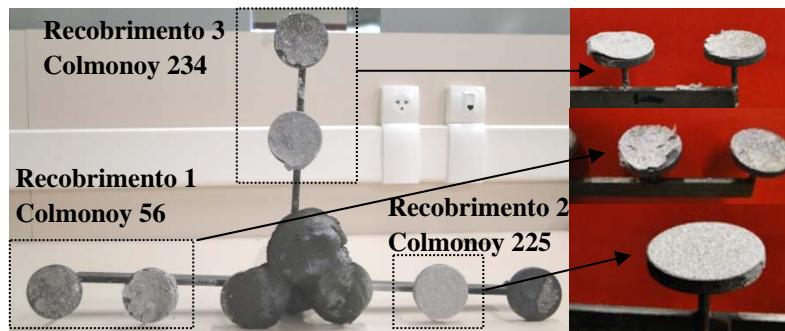
Figura 5.13 Fotografias de recobrimentos feitos partindo de pré-camadas produzidas pelas ligas de níquel Colmonoy 56 (Ni-Cr-Fe), Colmonoy 234 (Ni-Cr-Mo) e Colmonoy 225 (Ni-Si-P).
