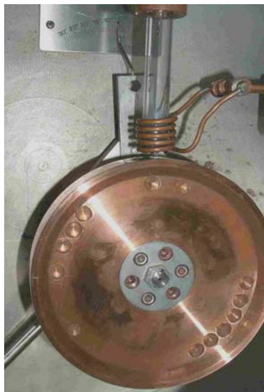
Figura 4.2 Equipamento melt-spinning para produção de fitas.
