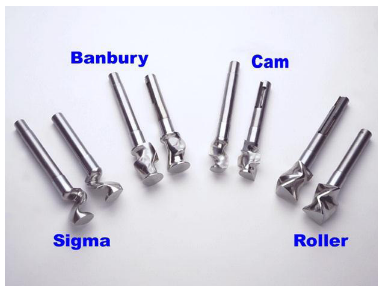
Figura 2.7 – Geometria dos rotores utilizados em reômetro de torque [25].
