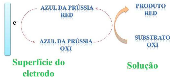
Figura 6: Representação da atuação do PB como mediador de elétron. Figura adaptada de [32]
