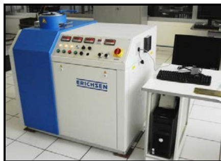
Figura 3.5 Embutidora utilizada nos ensaios de estampagem para levantamento da CLC.
