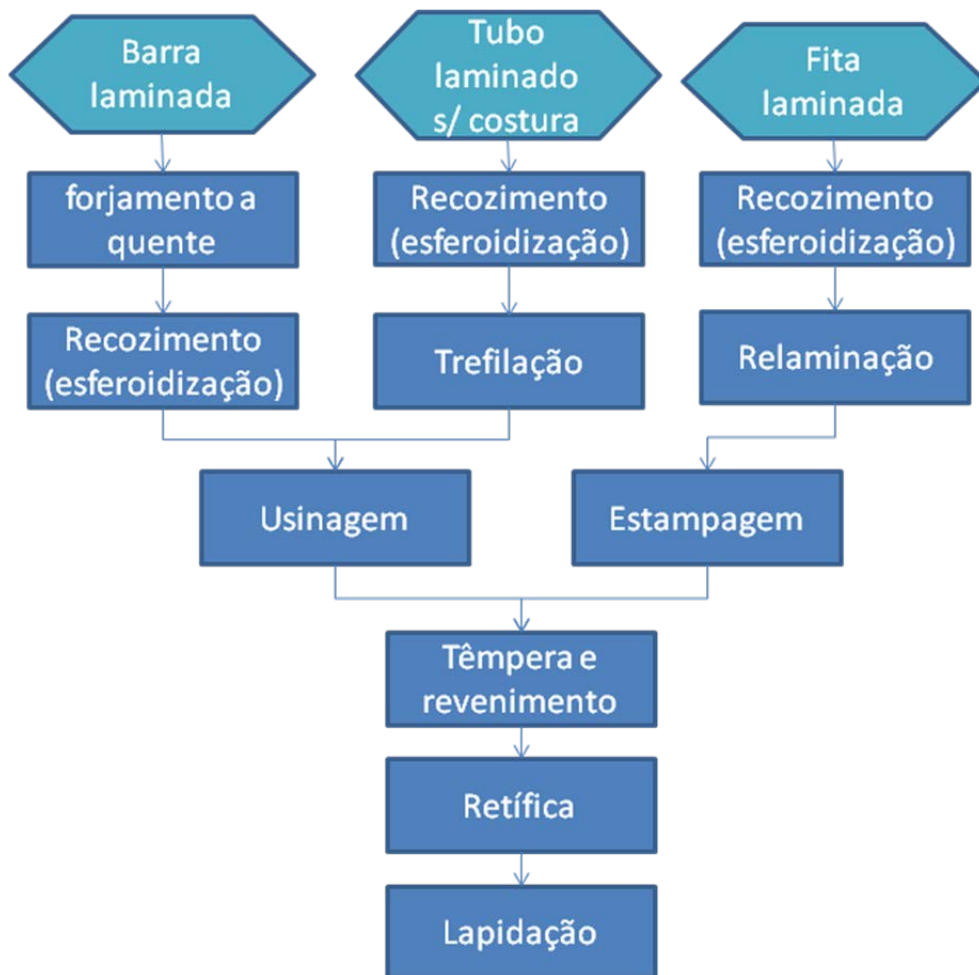
Figura 1.2 Fluxos de produção de anéis de rolamento a partir de barra laminada, tubo sem costura ou fita laminada.
