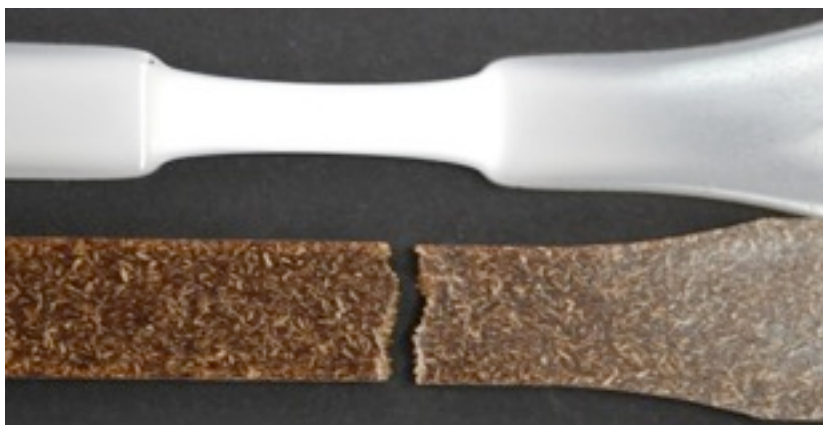
Figura 3.35: Comparação dos tipos de falha, térmica por escoamento no PP puro e falha mecânica por propagação de trica nos compósitos reforçados com fibra de coco.
