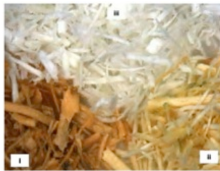
Figura 3.8: Micrografia óptica da fibra de coco não branqueada (i), após a primeira etapa (ii) e (iii) etapa final do tratamento de branqueamento.
