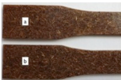
Figura 5.3: Fotografia de parte de corpos de prova de tração, em que a fibra de coco foi, (a) alimentado no 5° barril e (b) alimentado no 8° barril.
