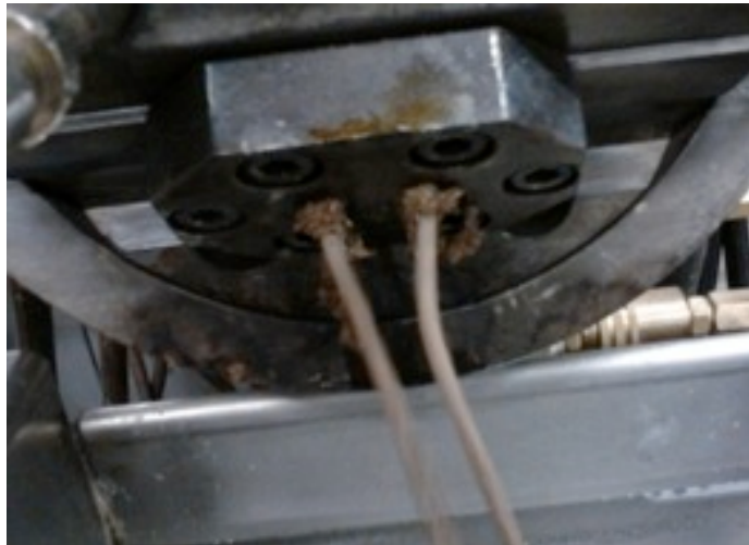
Figura 4.6: Tentativa de processar a formulação PP/40FCo 2 /30T/3C.
