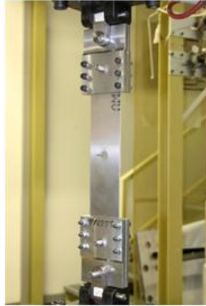
Figura 4. 9 - Amostra durante teste de fadiga.
