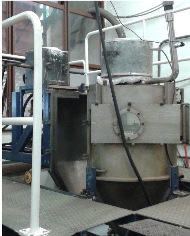
Figura 4.1 – Equipamento utilizado para a conformação por spray (Laboratório de Fundição, DEMa/UFSCar).
