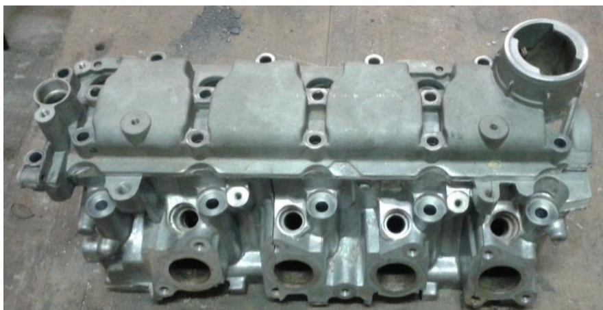
Figura 3.1 – Imagem de um cabeçote de motor, uma das principais aplicações da liga de alumínio 319.
