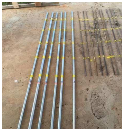
FIGURA 4: Hastes graduadas a cada 30 centímetros utilizadas para amostragem nas pilhas de cavacos
