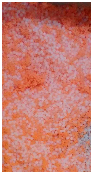
FIGURA 5 - Mistura de 7% de PU micronizado com PEAD
