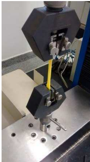
FIGURA 7 - Fotografia de um corpo de prova submetido ao Ensaio de Tração
