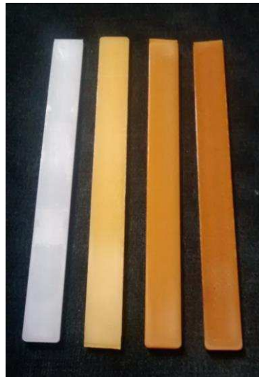
FIGURA 14 - Fotografia de alguns dos c.d.p. injetados para ensaios de flexão
