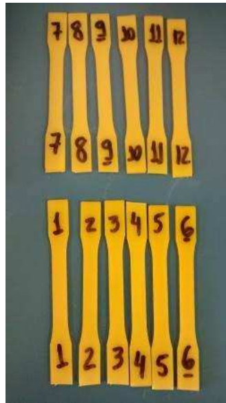
FIGURA 8 - Fotografia de alguns c.d.p. obtidos para ensaio de tração (PEAD +2%PU)
