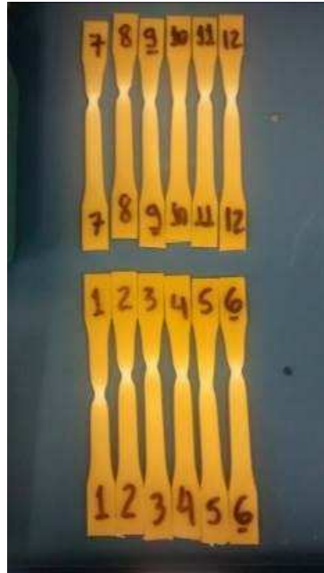
FIGURA 27 - C.d.p. após realização de Ensaio de Tração
