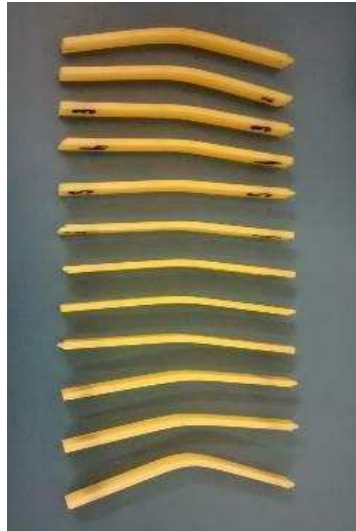
FIGURA 19 - Fotografia de c.d.p. após realização de ensaio de flexão
