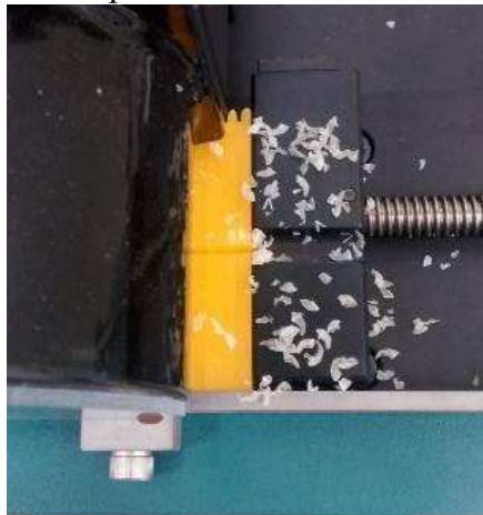
FIGURA 11 - Fotografia de um c.d.p. PEAD +2%PU submetido a procedimento de entalhe
