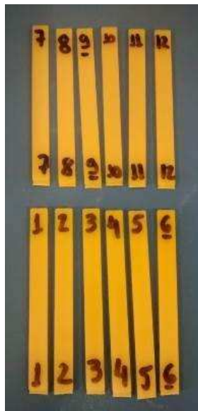
FIGURA 10 - Fotografia de alguns corpos de prova para ensaio de flexão (PEAD +2%PU)
