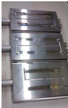
FIGURA 6 - Moldes para injeção de corpos de prova
