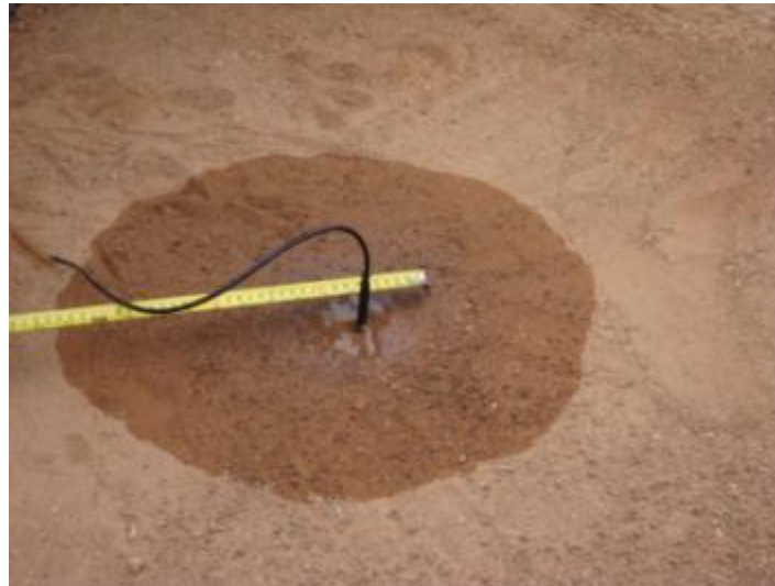
Figura 11. Medição do disco saturado e da frente de umedecimento.
