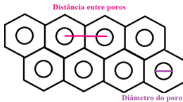
Figura 5: Ilustração teórica do diâmetro/distância poro.
