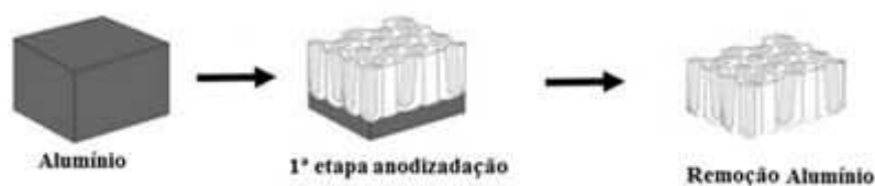
Figura 34: Metodologia utilizada para obtenção das amostras para análise de RBS
