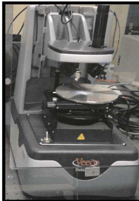
Figura 32 - Imagem ilustrativa do perfilômetro Veeco (DEKTAK 150) da UNESP – Sorocaba.
