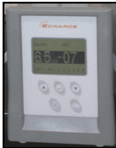
Figura 29 - Monitor de vácuo (Edwards), mostrando a pressão utilizada no processo de metalização por evaporação resistiva.
