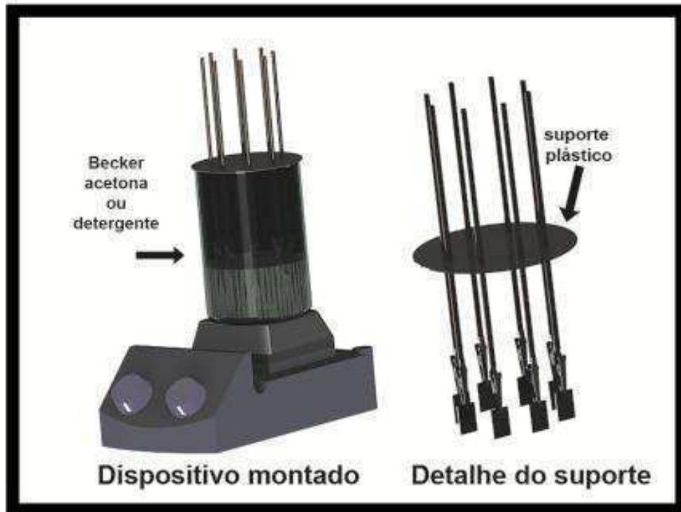
Figura 13 - Esquema de montagem das amostras para limpeza utilizando solução de detergente por 30 min. em temperatura de 60 °C e acetona por 30 min. em temperatura ambiente.
