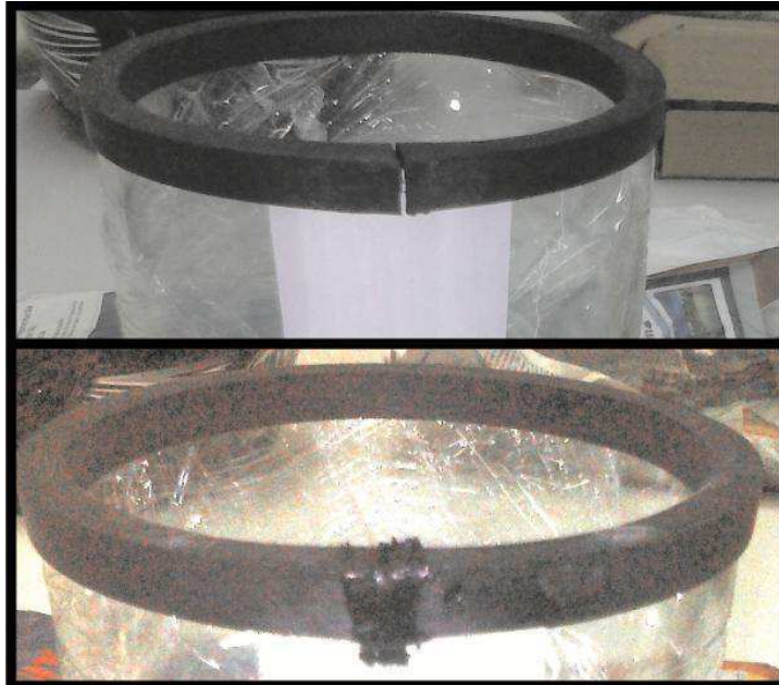
Figura 25 - Imagens da vedação de perfil “U” antes e depois – união das duas extremidades do perfil.
