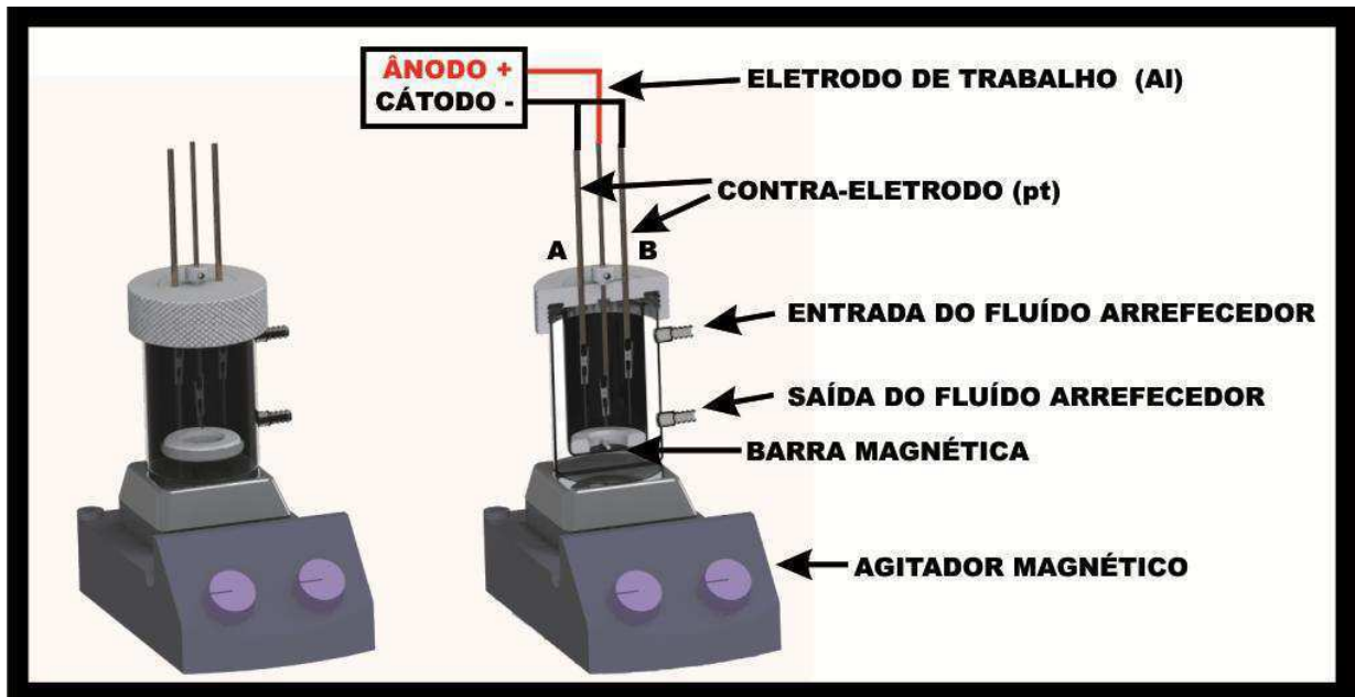
Figura 14 - Esquema ilustrativo do reator de eletropolimento com detalhamento da posição dos contra eletrodos.
