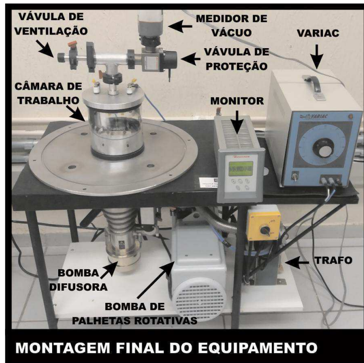
Figura 49 – Descrição da montagem final da metalizadora por evaporação térmica resistiva e a disposição real dos componentes mecânicos e elétricos.
