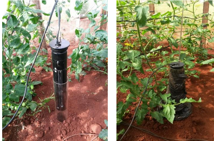
Figura 7 – Detalhe da entrada do scanner de raízes no tubo de acrílico (à esquerda) e leitura com o tubo vedado por saco plástico preto para impedir a entrada de luz (à direita).
