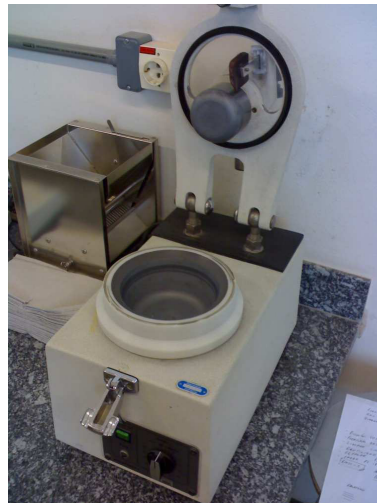
Figura 5.15 Moinho excêntrico, no qual o clínquer Portland de RB foi moído.
