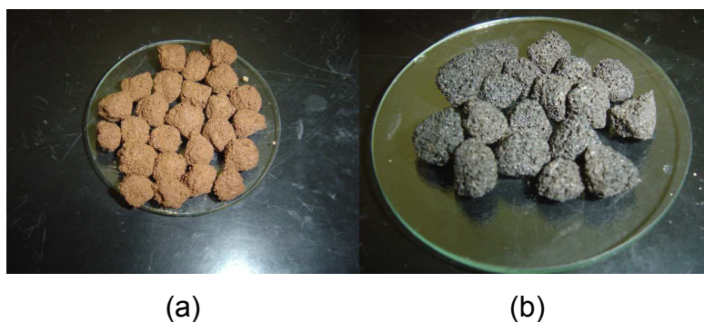
Figura 5.16 (a) pelotas de farinha de RB; (b) pelotas do clínquer Portland com RB após a queima a 1450°C.
