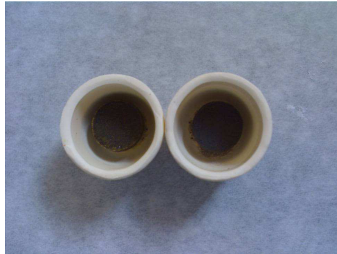
Figura 5.14 Pastilhas do clínquer Portland com RB após a queima a 1400 °C.
