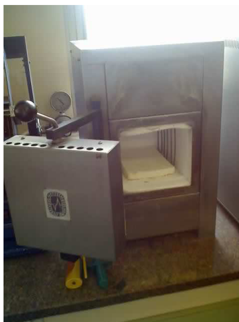
Figura 5.18 Mufla utilizada para a fabricação do clínquer com RB na ABCP
