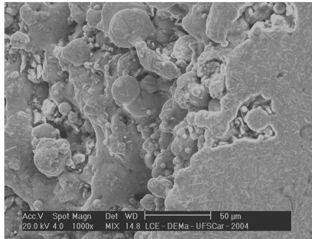
Figura 4.20. Micrografia mostrando a superfície no interior de um poro corresponde à região 1 (figura 4.18).
