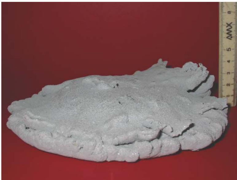
Figura 4.17. Foto do depósito após deposição por Conformação por Spray.
