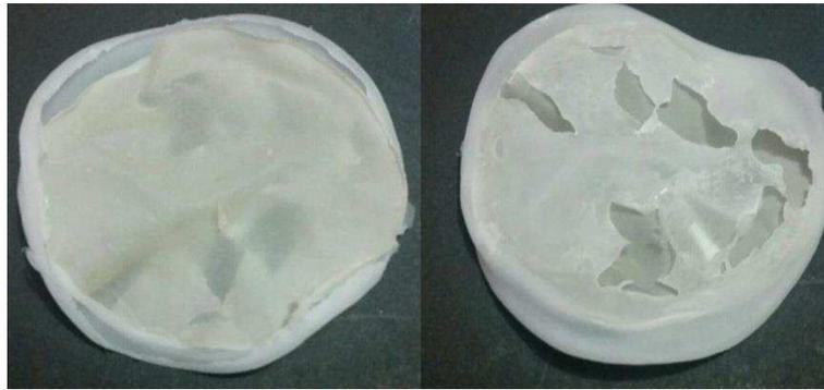
Figura 5.16 – Vista lateral do filme de polietileno com filme não tratado de nanofibrilas.
