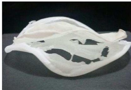
Figura 5.17 – Junção dos filmes de polietileno com filmes de nanofibrilas de celulose não tratada e tratadas com oxigênio (A e C) e com hexafluoreto de enxofre (B e D).
