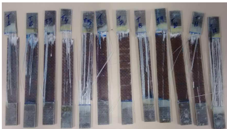
Figura 4.13 - Corpos de prova de laminado híbrido (H0/90) fraturados após ensaio de tração.
