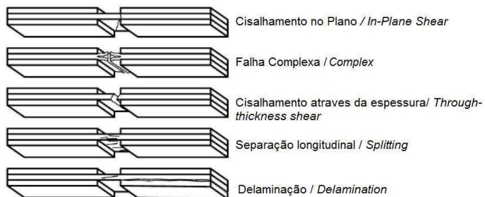
Figura 3.26 – Modos de falha válidos em um ensaio de compressão de acordo com ISO14130.
