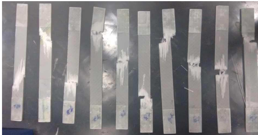
Figura 4.12 - Corpos de prova de laminado de fibra de vidro (G0/90) fraturados após ensaio de tração.
