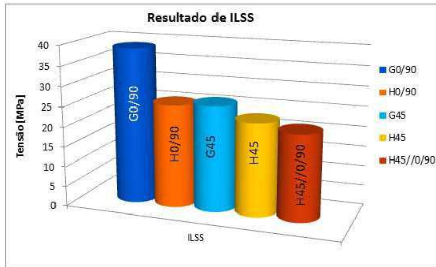
Figura 4.43 – Ampliação dos resultados de Resistência ao Cisalhamento Interlaminar (ILSS)
