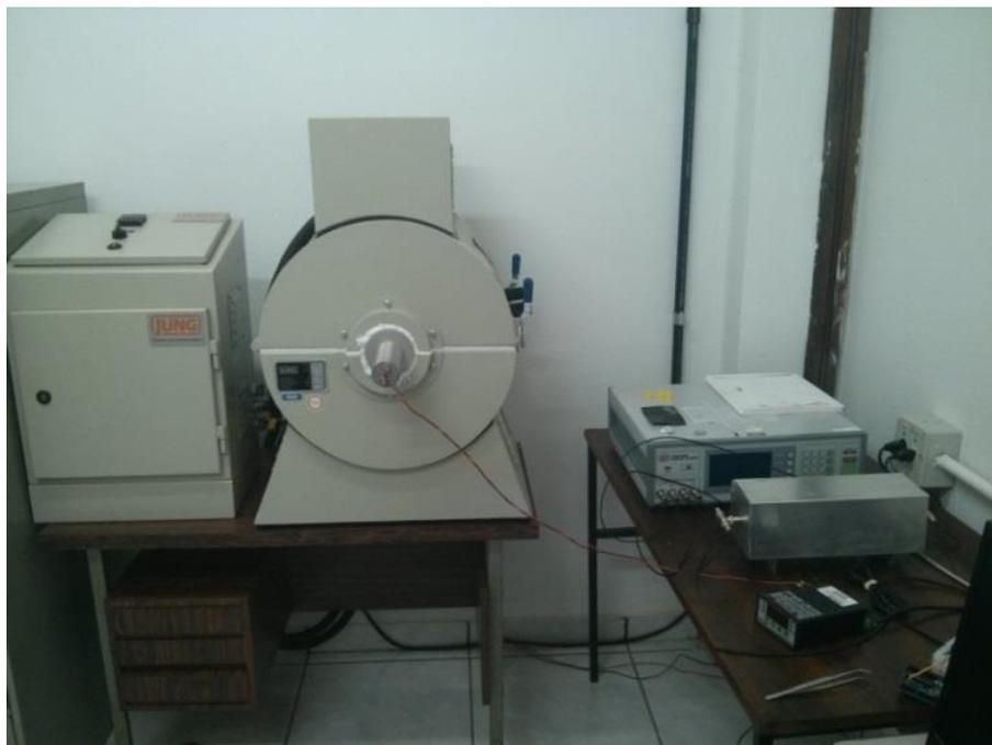
Figura 21: Aparato experimental de espectroscopia de impedância elétrica.
