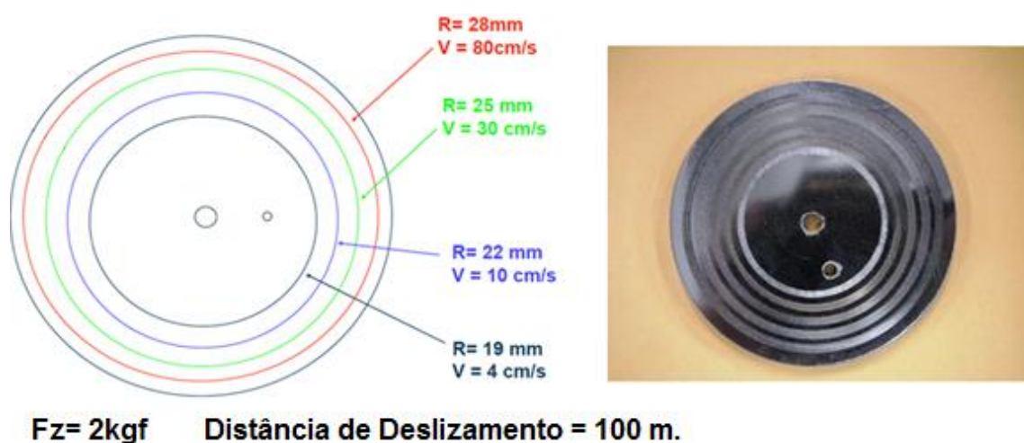
Figura 4.6 Representação esquemática dos parâmetros utilizados nos ensaios de pino-sobre-disco (R = raio do disco; V = Velocidade).
