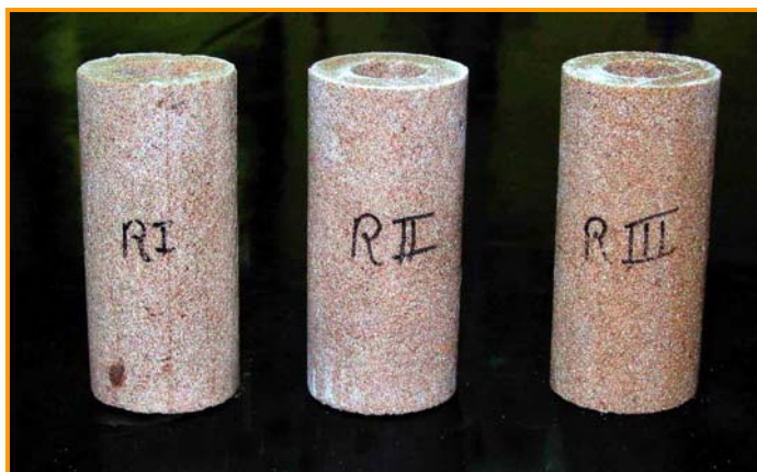
Figura 3.3 - Moldes de areia confeccionados com areia fina (RI), média (RII) e grossa (RIII), aglomerados com resina fenólica.
