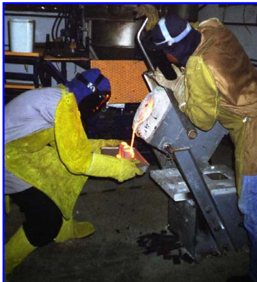
Figura 4.5: Vazamento de metal em escala laboratorial
