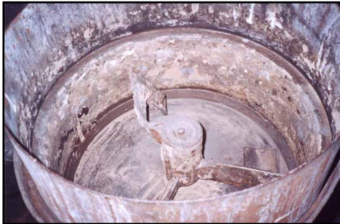
Figura 3.4 - Misturador de hélice utilizado para homogeneização da areia com o ligante cimento de fosfato de magnésio e água.
