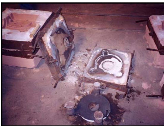
Figura 4.13: Fotografias das etapas de confecção do molde, vazamento de metal e desmoldagem da peça fundida na Fundição Metallux (São Carlos - SP).
