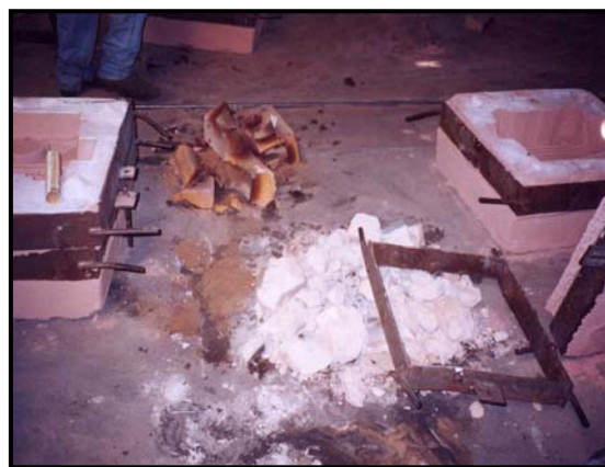
Figura 4.13: Fotografias das etapas de confecção do molde, vazamento de metal e desmoldagem da peça fundida na Fundição Metallux (São Carlos - SP).
