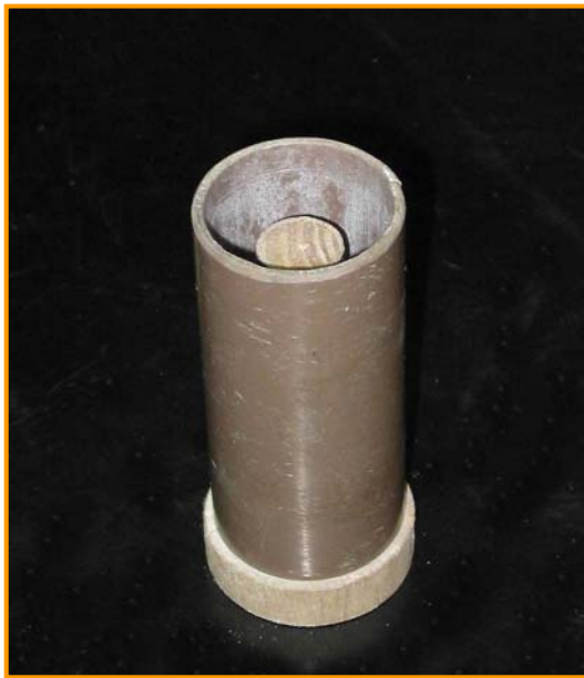
Figura 3.2 - Modelo utilizado para confecção dos moldes em escala laboratorial.
