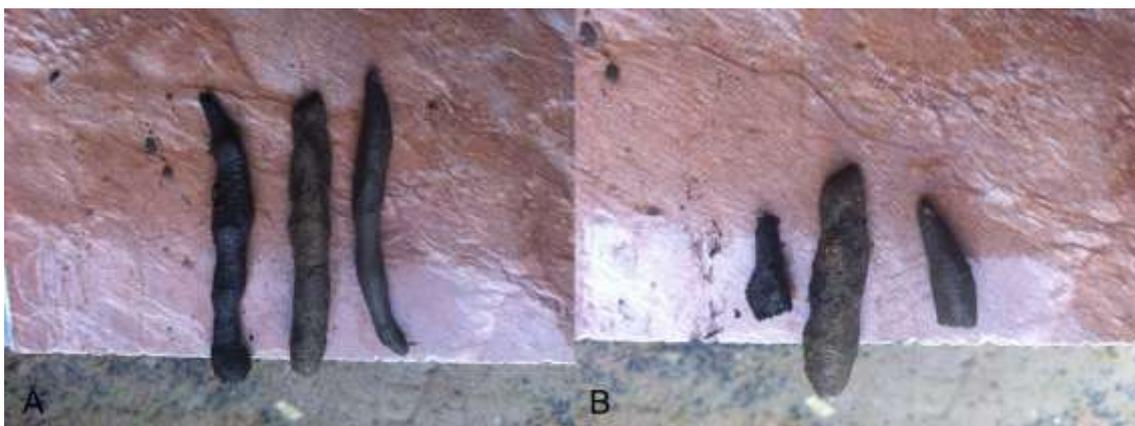
Figura 16 – Exemplo do experimento participativo para caracterização da estrutura do solo. Em (A) tem-se as amostras antes de serem empurradas em direção à borda, e em (B) após a ação. FONTE: O autor, 2016.
