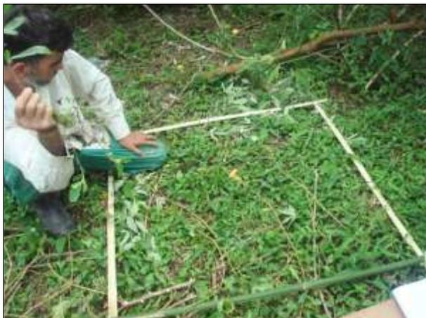
Figura 8 – Gabarito de 1 m<sup>2</sup> utilizado nas aferições. FONTE: O autor, 2016.
