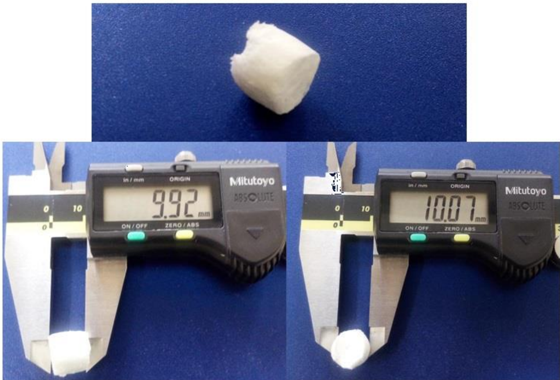
Figura 26 – Arcabouço poroso produzido com a Poli(PCL-TMC)uretana através do processo de liofilização.
