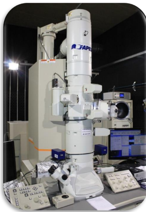
Figura 21 – Microscópio de transmissão eletrônica TEM-MSK nas instalações do LNNano.
