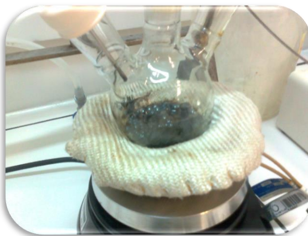
Figura 40 – Produto da reação por decomposição térmica do \text{Fe}(\text{acac})_3 em atmosfera controlada de \text{N}_2 resultando em nanopartículas de \text{Fe}_3\text{O}_4 .
