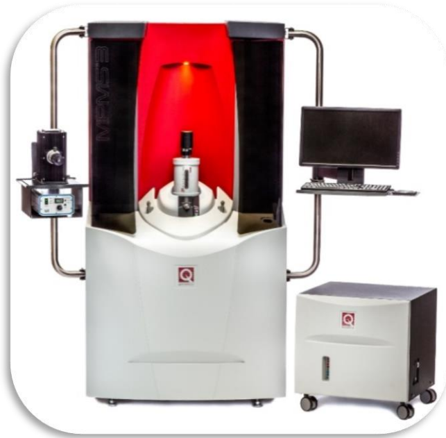
Figura 26 – Equipamento MPMS3 – S.Q.U.I.D. da Quantum Design utilizado nas instalações do CBPF.
