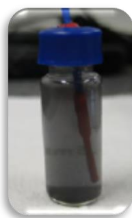
Figura 57 – Frasco de vidro contendo NPs suspensas para a medição do SAR. No interior do frasco foi colocado a fibra ótica para a aferição da temperatura.
