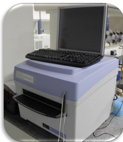
Figura 33 – Espectrofotômetro de absorção Perkin EnSpire Multimode Reader que mede a viabilidade celular via MTS; este equipamento encontra-se situado nas dependências do LNBio.
