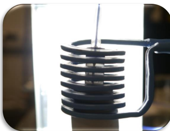
Figura 58 – Submissão das amostras NP@PEG, NP@CH, NP@CTAB, NP@SDS e NP@DSPE ao campo magnético externo oferecido pela bobina do equipamento de hipertermia magnética. Quando submetidos a esse campo as NPs se alinham de acordo com o gradiente axial do campo formando linhas de NPs nas paredes da vidraria conhecidas como needles.
