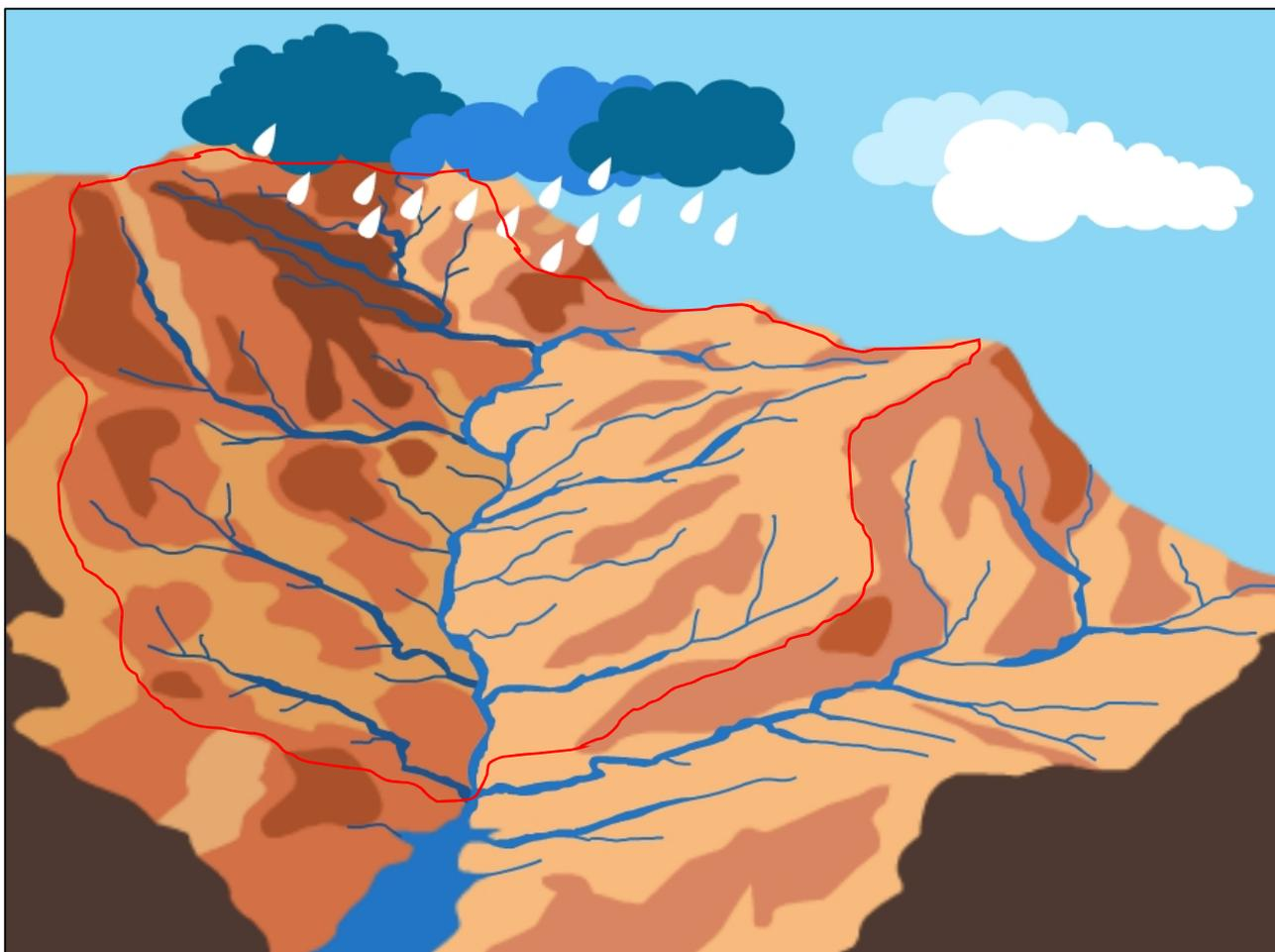
**Figura 4:** Representação possível da definição de uma bacia de hidrográfica, em vermelho. Fonte: adaptado de GEO Conceição, 2017.
