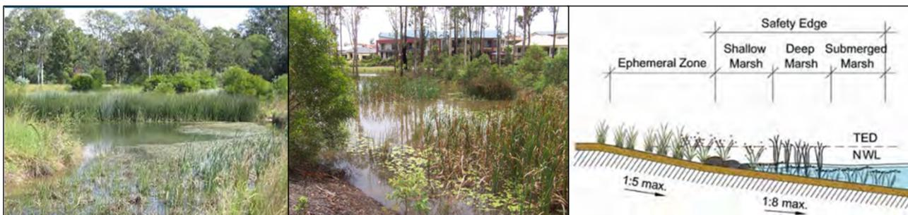
**Figura 14:** Exemplos australianos de wetlands construídos e perfil marginal. Fonte: JCSWSC, 2009.
