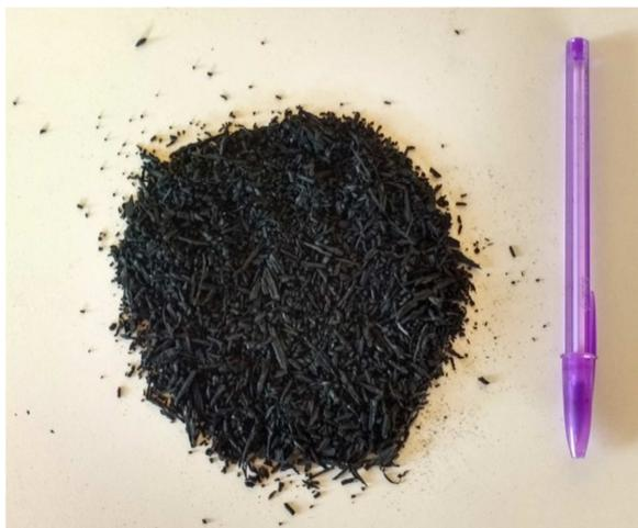
Para a caracterização e classificação do material foram realizados procedimentos experimentais devidamente normatizados, para determinação da composição granulométrica, determinação da massa específica, lixiviação e solubilização.
