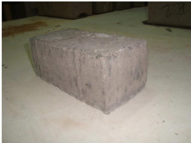
A Figura 43 traz as imagens de alguns dos *pavers* fabricados com os resíduos propostos. Não houve uma variação considerável da cor das peças, uma vez que o resíduo aplicado, apesar de apresentar uma coloração mais escura do que o agregado natural, a quantidade substituída não foi o suficiente para influenciar neste quesito.
