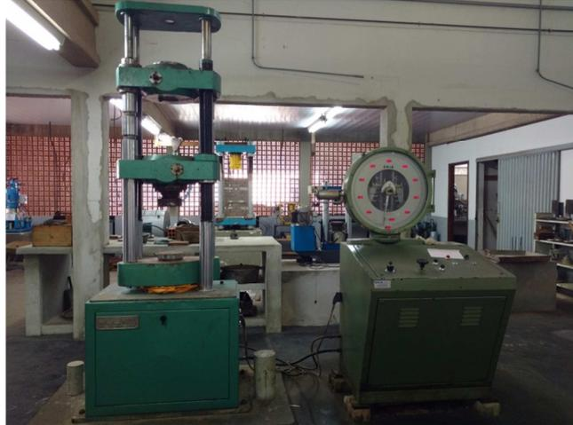
Para realização do ensaio de acordo com a NBR 9781:2013 (ABNT, 2013) o corpo de prova deve ser colocado centralizado com as placas auxiliares da prensa, discos de aço com diâmetro de  $90 \pm 0,5$ mm, conforme mostrado na Figura 32, simulando, assim, o esforço que o *paver* deverá suportar durante o sua utilização.
