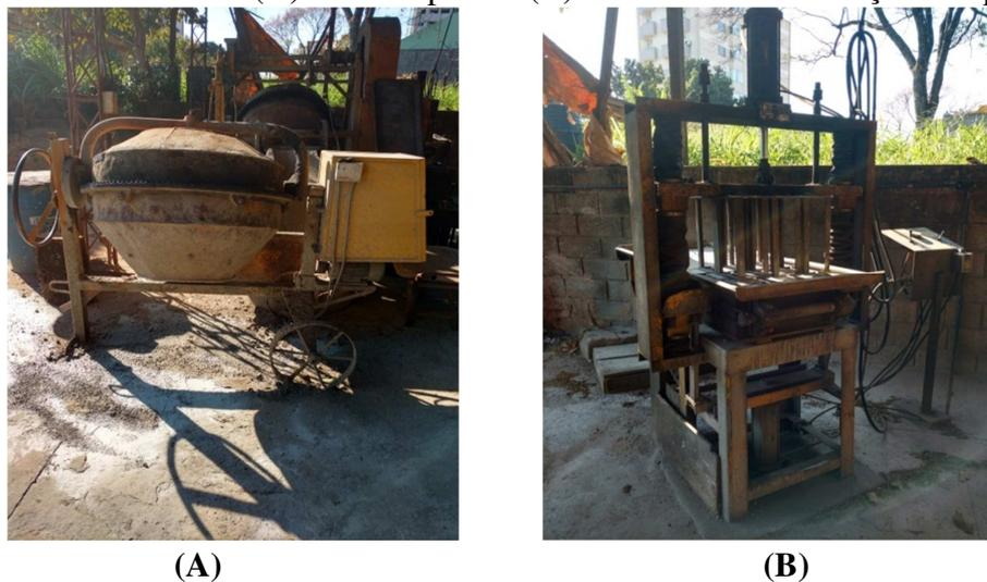
O concreto depois de misturado é colocado na vibro-prensa, onde inicialmente é vibrado, acomodando as partículas de concreto seco (Figura 29 A); logo após é prensado e vibrado ao mesmo tempo. O molde ascende (Figura 29 B) e a placa de madeira móvel que acomoda os *pavers* é removida (Figura 29 C)..
