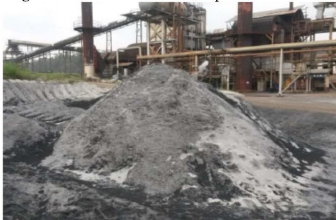
A cinza é resultante de um processo de queima sem controle da temperatura, em torno de 900°C a 1000°C, onde seu rendimento varia de acordo com a umidade do bagaço e do tipo de solo (argiloso ou de terra vermelha) de onde a cana é colhida. Segundo a Usina, cada tonelada de bagaço queimado gera em torno de 14 kg de cinza pesada, sendo geradas
