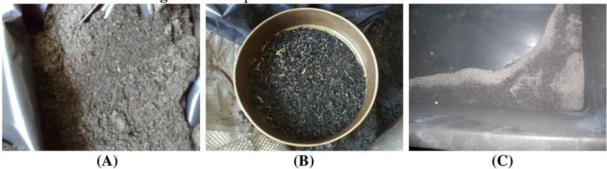
Para a caracterização e classificação do material foram realizados procedimentos de determinação de atividade pozolânica, determinação de composição granulométrica, determinação de massa específica, lixiviação e solubilização de acordo com as normas vigentes.
