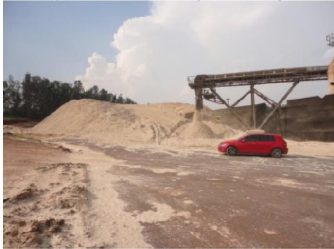
Durante o processo da queima do bagaço a cinza cai na parte inferior da fornalha e é transportada por de correias transportadoras, constantemente resfriadas, até montes de cinza depositados a céu aberto diretamente sobre o solo, conforme a Figura 19. Diariamente é realizada a coleta destas cinzas, que são posteriormente misturadas à torta de filtro, outro resíduo do processo de produção da usina, e lançado como “fertilizante” nas plantações de cana-de-açúcar.
