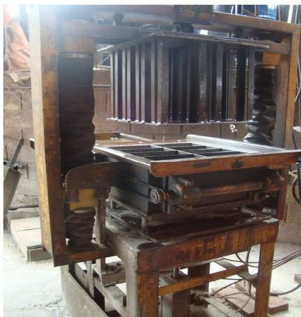
Este tipo de equipamento trabalha com a vibração associada à prensagem, onde a primeira é responsável pelo preenchimento e adensamento do concreto nas formas e a segunda pelo adensamento e controle das dimensões das peças (HOOD, 2006). Existem
