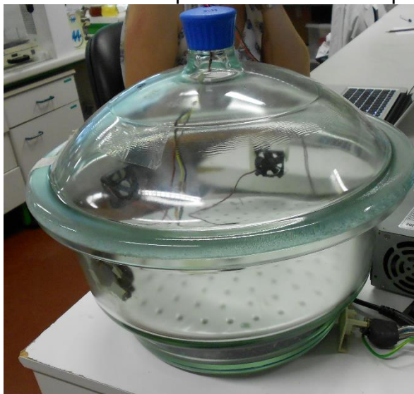
Figura 4 – Dessecador com ventoinhas para circulação de ar durante a realização de ensaios de permeabilidade ao vapor d'água.
