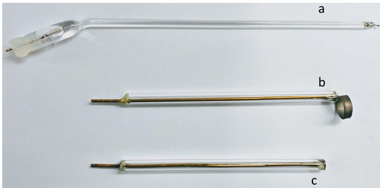
Figura 3.4 – Eletrodos utilizados neste trabalho: (a) eletrodo de referência (ER), (b) contra eletrodo (CE) e (c) eletrodo de trabalho (ET). Fonte: Próprio autor.
