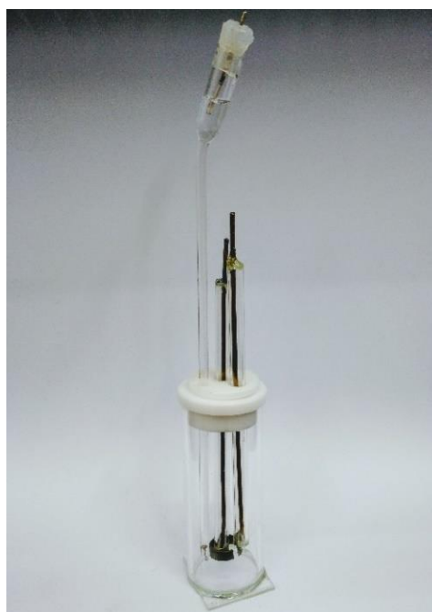
Figura 3.5 - Célula de vidro com os eletrodos posicionados.
