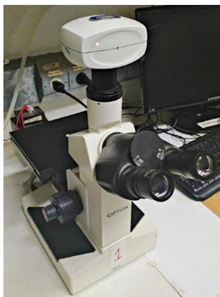
Figura 3.2 – Microscópio trinocular invertido. As imagens são obtidas por uma câmera digital acoplada na parte superior do microscópio.
