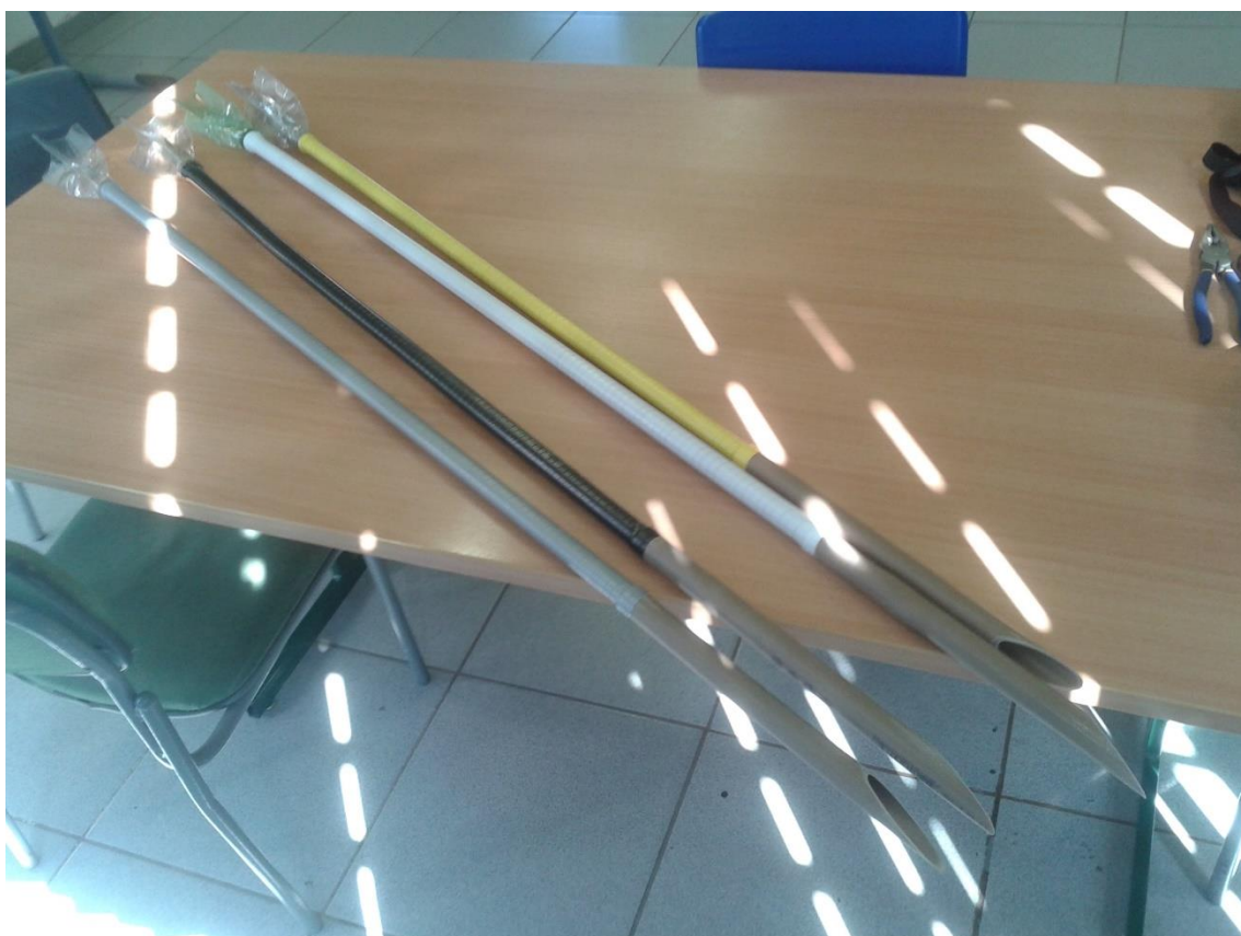
FIGURA 18: dardos de sucata construídos conforme Nakamoto (2013)
