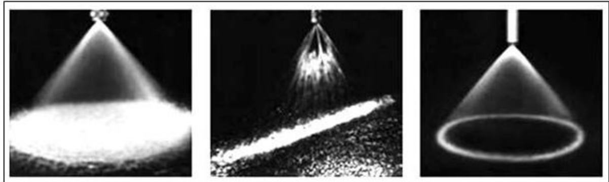
Figura 2.14- Jatos do tipo cone sólido, leque e cone oco, respectivamente.
