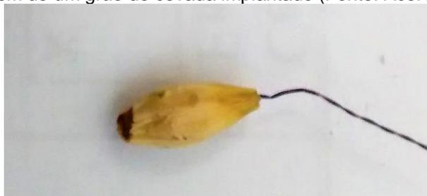
Após esta preparação, iniciava-se a aquisição de temperaturas e então o sistema de grão e termopar foi inserido no escoamento de ar.
