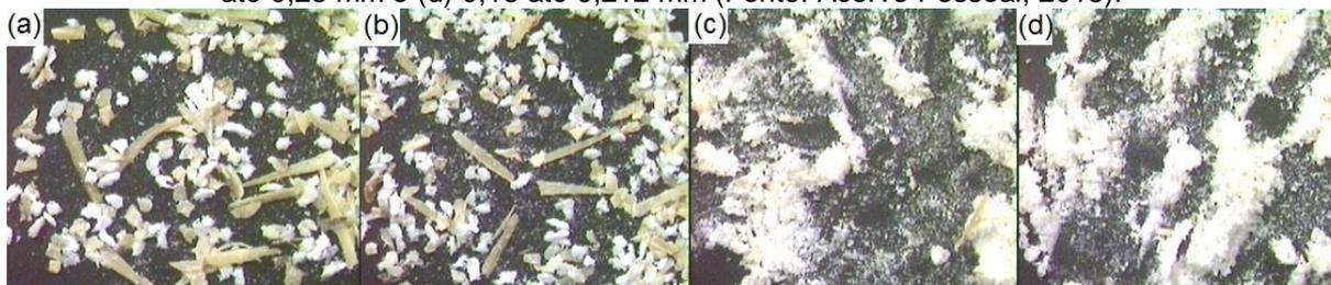
Como meio de comparação, na Figura 48 estão as imagens das partículas da casca moída retidas nas peneiras de mesmas faixas granulométricas analisadas nas Figura 46 e Figura 47.
